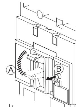
(A): Intervento per sovraccarico o corto circuito / Tripped due to over-load or short-circuit / Intervention due à une surcharge ou un court-circuit / Intervención por sobrecarga o cortocircuito / Auslösung wegen Überstrom oder Kurzschluss
