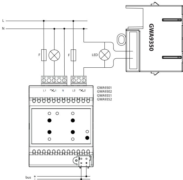
Adattatore di carico 230Vac 50Hz per lampade a LED dimmerabili, installare in prossimità del carico.
