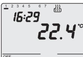
Funcțiile **antiînghet/protecție la temperaturi ridicate** sunt active atât în modul de încălzire, cât și în cel de răcire (aer condiționat).
