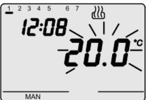
Para activar la modalidad de funcionamiento manual, presionar la tecla MODE, hasta que en la pantalla aparezca la nota MAN. El set point de temperatura empieza a parpadear durante 2 seg. Con las teclas **▲▼** programar el valor del set point deseado, presionar la tecla MODE o esperar 5 segundos para confirmar la programación.
