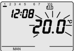
Zur Aktivierung des Handbetriebs die Taste MODE drücken, damit auf dem Display das Symbol MAN angezeigt wird. Der Temperatursollwert beginnt für ca. 2 Sekunden zu blinken. Mit den Tasten den gewünschten Sollwert einstellen, die Taste MODE drücken, oder 5 Sekunden warten, um die Einstellung zu bestätigen.
