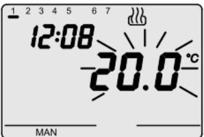
Per attivare la modalità di funzionamento manuale, premere il tasto MODE, finché sul display appare la scritta MAN. Il set point della temperatura inizia a lampeggiare per circa 2 sec. Con i tasti impostare il valore del set point desiderato, premere il tasto MODE o attendere 5 secondi per confermare l'impostazione.
