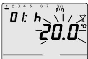
Para activar la función presionar durante 5" la tecla MODE: en la pantalla aparecerá el símbolo mientras parpadea el valor de set point activo en ese momento. Con las teclas **▲▼** programar el nuevo valor del set point de temperatura.
