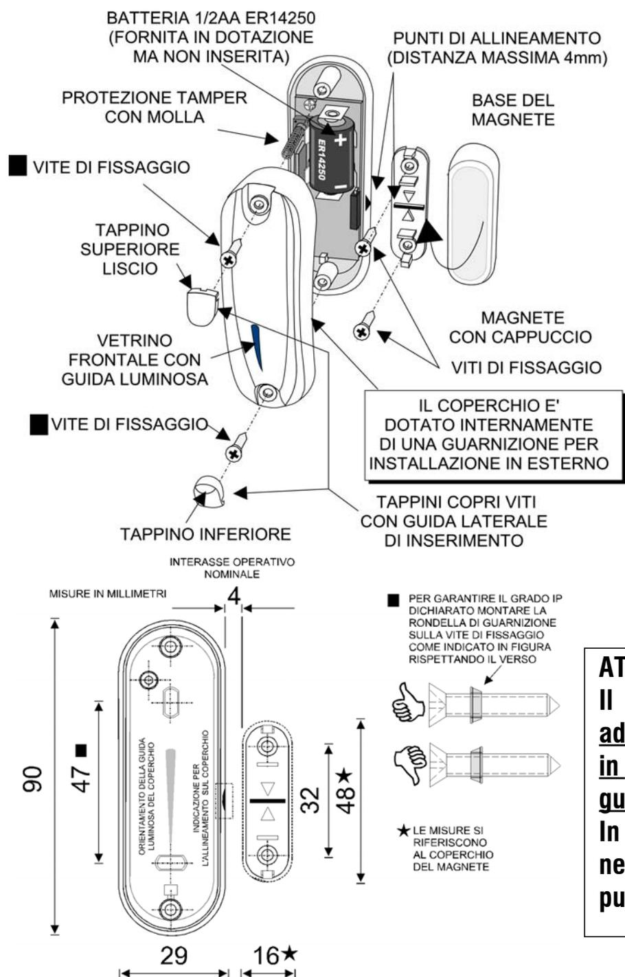
**Nota:** nella figura è suggerito l'orientamento preferenziale del trasmettitore per ottenere il massimo del segnale radio. E' possibile ottimizzare la posizione del trasmettitore osservando le indicazioni dell'intensità del segnale radio che la centrale o altro ricevitore compatibile può visualizzare.
