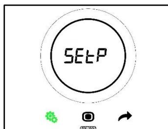
2. Die Taste MODE
