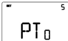
Wenn die Funktion aktiviert ist, kann durch einen Druck auf die Taste auf die Seite für die Einstellung des Zeitraums ohne Eingabe zugegriffen werden. Mit den Tasten oder kann der Zeitraum eingestellt werden (von 5 bis 120 Sekunden). Um die Auswahl zu bestätigen und zum nächsten Parameter zu springen, die Taste innerhalb von 30 Sekunden drücken.
