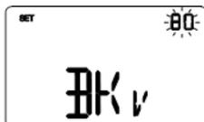
Wenn die Verwaltungsart SENS ist, die Tasten oder benutzen, um den vom eingebauten Dämmerungssensor erfassten Wert zu erhöhen (+10%), zu senken (-10%) oder gleich zu lassen (0%).
