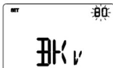
Si le type de gestion est SENS, utiliser les touches ou pour incrémenter (+10%), décrémenter (-10%) ou ne pas modifier (0%) la valeur de luminosité relevée par le capteur crépusculaire installé.
