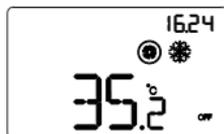
Le **fonctionnement en protection contre les hautes températures** n'est actif qu'en refroidissement, avec l'installation de thermorégulation éteinte (OFF).
