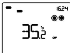
El **funcionamiento de protección de altas temperaturas** está activo solo en refrigeración, con la instalación de termostato apagada (OFF).
