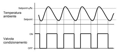
Quando la temperatura misurata è superiore al valore "setpoint+ $\Delta Tc$ " (dove  $\Delta Tc$  identifica il valore del differenziale di regolazione del condizionamento) il dispositivo attiva l'impianto di condizionamento inviando il relativo comando bus all'attuatore che lo gestisce; quando la temperatura misurata raggiunge il valore del setpoint impostato, il dispositivo disattiva l'impianto di condizionamento inviando il relativo comando bus all'attuatore che lo gestisce.
