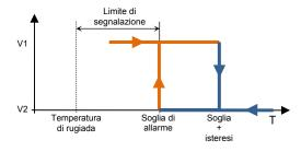
Il limite di segnalazione permette ha lo scopo di identificare l'avvicinarsi della temperatura di rugiada, definendo di fatto quando prima del raggiungimento della temperatura di rugiada debba essere inviato il comando associato all'allarme temperatura di rugiada. Il valore iniziale del limite viene definito attraverso il parametro "Limite di segnalazione allarme [decimi di °C]", che può assumere i seguenti valori:
