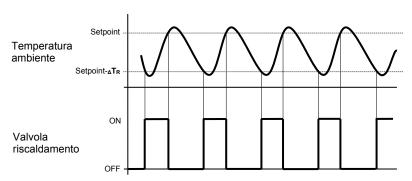
Quando la temperatura misurata è inferiore al valore "setpoint- $\Delta T_R$ " (dove  $\Delta T_R$  identifica il valore del differenziale di regolazione del riscaldamento) il dispositivo attiva l'impianto di riscaldamento inviando il relativo comando bus all'attuatore che lo gestisce; quando la temperatura misurata raggiunge il valore del
