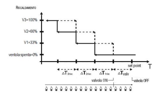
La figura si riferisce al controllo delle velocità del fancoil con tre stadi di funzionamento per quanto riguarda il riscaldamento. Osservando il grafico, si nota come per ogni stadio esista un ciclo di isteresi, nonché ad ogni velocità sono associate due soglie che ne determinano l'invio del valore associato. Le soglie vengono determinate dai valori impostati ai vari differenziali di regolazione, e si possono così riassumere:
