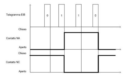
L'uscita ausiliaria implementa la funzione scenari, che permette di replicare un determinato stato del contatto precedentemente memorizzato a fronte della ricezione del comando di esecuzione scenario. L'oggetto di comunicazione *Uscita aux - Scenario* (Data Point Type: 18.001 DPT\_SceneControl) viene utilizzato per ricevere da bus i comandi di esecuzione e memorizzazione scenario. Il dispositivo gestisce al massimo 8 scenari, con indice compreso tra 0 e 7.
