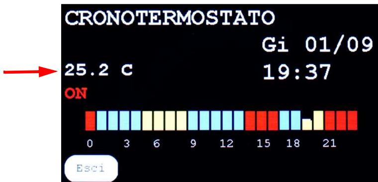
Se l'offset non è stato regolato (solo dopo 30 minuti di accensione continua del display) , la temperatura apparirà lampeggiante.
