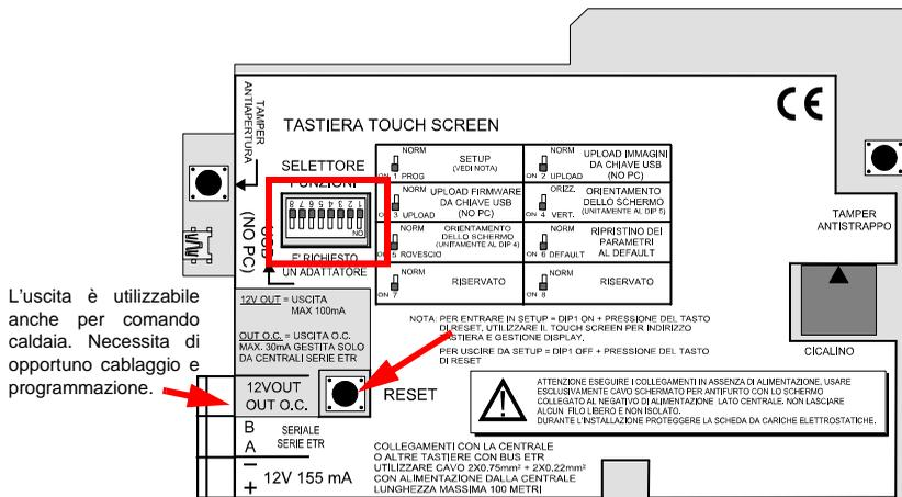
L'uscita è utilizzabile anche per comando caldaia. Necessita di opportuno cablaggio e programmazione.
