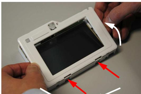
Eseguire un movimento a libro per unire il coperchio con il fondo. Controllare che la bobina del lettore di chiavi GW20474 entri al centro delle 4 torrette trasparenti del coperchio.
