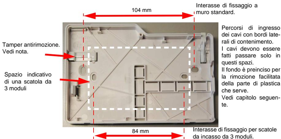
**Nota:** è necessario l'utilizzo di un tassello fissato al muro in corrispondenza del foro del Tamper indicato dalla freccia. Inserire una vite nel tassello con diametro della testa Ø5 millimetri circa regolandone l'altezza in modo che arrivi a 2 millimetri dal bordo interno del fondo.
