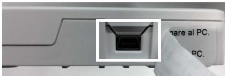
Per impedire il collegamento accidentale di un PC utilizzando un cavo tipo macchina fotografica digitale, il connettore è protetto da una etichetta con avvertenze. La rimozione implica la perfetta comprensione di quanto è scritto. Guasti dovuti al collegamento errato del connettore non saranno quindi coperti da garanzia.
