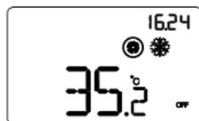
Il **funzionamento protezione alte temperature** è attivo solo in raffrescamento, a impianto di termoregolazione spento (OFF).
