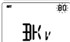
Se il tipo di gestione è SENS, utilizzare i tasti o per incrementare (+10%), decrementare (-10%) o lasciare invariato (0%) il valore di luminosità rilevato dal sensore crepuscolare a bordo.
