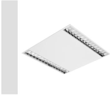
Apparecchio da incasso per controsoffitto modulare 600x600mm. Corpo in lamiera di acciaio verniciato bianco. Diffusore plastico prismaticizzato. Sorgente luminosa Mid Power LED.
