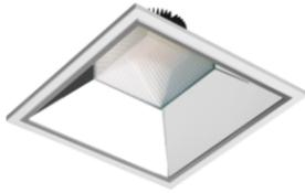
Apparecchio downlight quadrato da incasso per fissaggio a molla. Corpo in lamiera di acciaio. Riflettore in alluminio. Dissipatore termico in alluminio. Diffusore plastico trasparente prismaticizzato. Sorgente luminosa Mid Power LED. Disponibile anche in versione emergenza.
