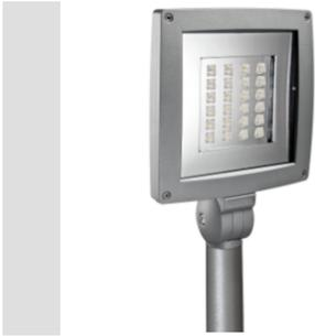
Proiettore in pressofusione di alluminio verniciato a polveri poliestere previo passivazione trivalente. Doppia rotazione dell'ottica grazie allo snodo centrale dotato di scala goniometrica graduata per agevolare i puntamenti. Vetro piano spessore 4 mm temprato. Guarnizione siliconica antinvecchiamento. Fornito di raccordo per installazione su palo diametro 50/76 mm. Versioni con tecnologia a LED monocromatica. Da completare con driver SELV esterno max 700 mA.
