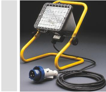
Proiettore polifunzionale in pressofusione di alluminio verniciato a polveri poliestere per impiego mobile su supporto tubolare Parabola in alluminio 99.85% brillantato e ossidato anodicamente Vetro piano temprato 5 mm spessore Guarnizione siliconica anti invecchiamento Adatto per utilizzo con lampade alogene Provvisto di gabbia di protezione e di cavo tipo H07RN-F sezione 3x1,5mm<sup>2</sup> di lunghezza 5m e spina IEC 309 16A 2P+T 200-250V IP67 per il collegamento elettrico
