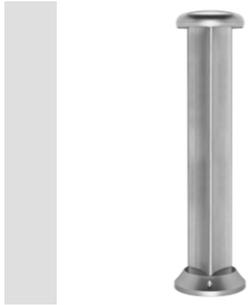
Luminaire de chemins/jardins en aluminium moulé sous pression et peint avec des peintures en poudre de polyester après passivation trivalente Cache en plastique Joint en silicone anti-vieillessement Principale source de lumière LED alimentée par une source électrique classique, LED secondaire avec lentille pour effet spot
