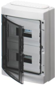
Coffret mural conforme aux normes allemandes, équipé de borniers bipolaires et de deux brides interchangeable (une bride à trous défonçables et une bride avec passe-fils à entrée rapide).
