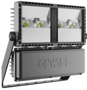
SMART[PRO]e 2M es un proyector LED de media potencia, para exteriores e interiores, adecuado para iluminar zonas e instalaciones deportivas pequeñas y medianas. Se puede instalar en la pared, techo o suelo gracias al soporte en acero galvanizado pintado con polvo de poliéster con pasivación trivalente, equipado con una escala goniométrica ajustable, suministrada en el kit.
