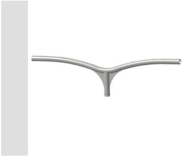
Brazo doble para extremo de poste en tubo de acero galvanizado en caliente de 3 y 4 mm de espesor, y pintado con polvo poliéster. Suministrado con tres tornillos de bloqueo M8, para fijación en postes de 60mm.
