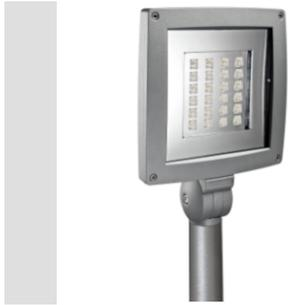
Proyector en aluminio inyectado y barnizado con polvo poliéster y pasivado previo trivalente. Rotación doble de la óptica gracias al nodo central equipado con escala goniométrica graduada para agilizar el apuntamiento. Cristal templado plano de espesor 4 mm. Juntas de silicona anti envejecimiento. Suministrado con base de conexión a postes de diámetro 50/76 mm. Versiones con tecnología LED monocromática. Para completar con driver externo SELV máx 700 mA.
