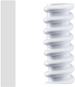
Flexible Rohre DF Diflex aus PVC, Klassifizierung 2311. Gemäß IEC 61386-1 (CEI 23/80) und IEC 61386-23 (CEI 23/83). Die Baureihe besteht aus 14 Größen, von 8 bis 60 mm, in den Farben Grau, Schwarz, und Blau. Geeignet für den Schutz von Kabeln und Leitungen in ortsfesten und ortsveränderlichen Installationen im privaten, gewerblichen und industriellen Bereichen dank der hohen Beständigkeit gegenüber Ölen. Installation: Aufputz, abgehängte Decken und Doppelböden.
