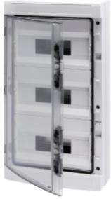
Wassergeschützte Verteiler IP65 von 4 bis 72TE mit transparenter Rauchglastür und mit mehrpoligen Schraub-Klemmleisten, 80 A IP 20. Die technischen Merkmale sind: Front und Gehäuse reversibel, abnehmbare Geräteträger und Abdeckungen mit Ausschnitt, abnehmbare Tür mit 180° Öffnung und Schloss als Zubehör. Die Klemmleisten ermöglichen eine einfache und übersichtliche Verdrahtung und verkürzen die Montagezeit.
