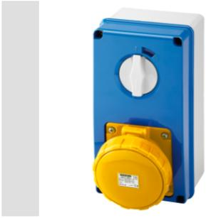
Industriesteckdosen gemäß IEC 309, mit mechanischer Verriegelung und Schutzschalter, erlauben das Stecken oder Ziehen des Steckers nur im ausgeschalteten Zustand und das Schalten nur bei eingestecktem Stecker. Umfangreiche Baureihe mit Drehschaltern, Sicherungssockeln, AUTOMATIKA mit 6kA LS-Schalter C Charakteristik und Versionen mit Sicherheitstrafos. Vielseitig einsetzbar durch Auf- und Unterputzgehäuse, sowie Flansche für die Montage in die Baureihe 68 Q-DIN und 68 Q-MC.
