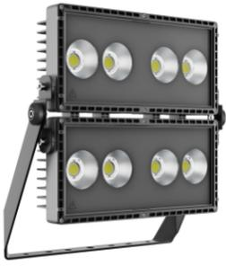
SMART[PRO]e 4M è un proiettore LED di alta potenza, per esterno e interno, adatto all'illuminazione di aree e impianti sportivi di medie dimensioni. Può essere installato a parete, a soffitto o a terra grazie alla staffa in acciaio zincato verniciato a polvere di poliestere con passivazione trivalente dotata di scala goniometrica regolabile, fornita in kit.
