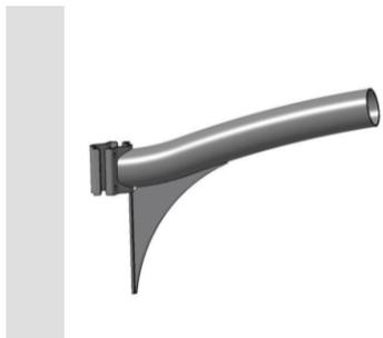
Staffa di fissaggio su pali di diametro da 60 a 75 mm realizzata in tubolare di acciaio, di spessore 3 mm, zincato a caldo e verniciato a polveri poliestere. Viteria in acciaio INOX.
