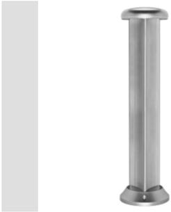
Apparecchio d'illuminazione per vialetti/giardino in estrusione e pressofusione di alluminio verniciata a polveri poliesteri previa passivazione trivalente. Schermo plastico. Guarnizione siliconica antinvecchiamento. Sorgente luminosa LED principale a tensione di rete, LED secondario con lente per effetto spot.
