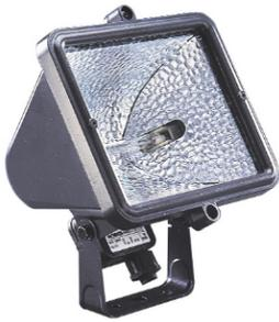
Proiettore polifunzionale in pressofusione di alluminio verniciato a polveri poliestere per impiego fisso. Parabola in alluminio 99.85% brillantato e ossidato anodicamente. Vetro piano temprato 5 mm spessore. Guarnizione silconica anti invecchiamento. Adatto per utilizzo con lampade alogene. Ingresso alimentazione tramite pressacavo per cavi di diametro 9 ± 12 mm.
