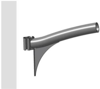
Support pour la fixation sur des poteaux de diamètre de 60-75mm, en tube acier galvanisé, 3 mm d'épaisseur, peint avec de la poudre polyester. Vis et écrous en acier inoxydable.
