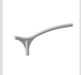
Support simple tête de poteau en tube acier galvanisé, 3 ou 4 mm d'épaisseur, peint avec de la poudre polyester. Fourni avec trois vis de blocage M8 en acier inoxydable pour la fixation sur des poteaux de diamètre de 60 mm.
