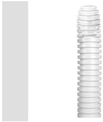
Conduits cintrables légers de la gamme FK9, en PVC, classés 22212, disponibles en six diamètres, de 16 à 50 mm, avec ou sans extracteur de câble, gris RAL 7035. Convient aux systèmes électriques et/ou de transmission de données. Recommandés pour une installation encastrée dans des murs verticaux ou des plafonds. Les conduits FK9 sont conformes aux normes EN 61386-1 et EN 61386-22.
