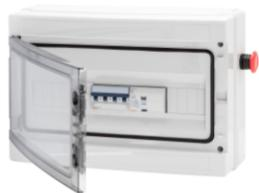
Principaux tableaux d'alimentation pour le site de construction (types 68 QP ACS et 68 CDK ACSK): installés juste en aval du compteur d'énergie afin de protéger la ligne entre le coffret d'alimentation et le tableau de distribution principal du site. Ils sont proposés dans des versions de 17 kW (32 A) à 130 kW (250 A) de puissance et sont tous équipés d'un bouton poussoir d'urgence.
