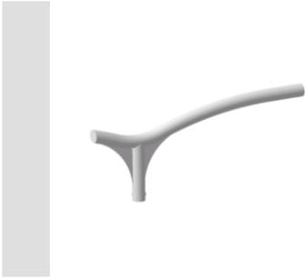
Brazo simple para extremo de poste en acero de 3 y 4 mm de espesor galvanizado en caliente y pintado con polvo poliéster. Suministrado con tres tuercas de acero M8 para fijación en postes de 60mm de diámetro.
