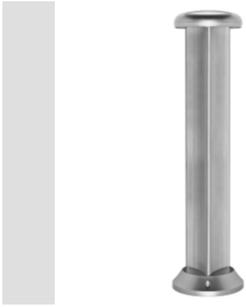
Aparato de iluminación de viales/jardines en extrusión de aluminio, barnizado con polvo poliéster y pasivado trivalente previo. Pantalla plástica. Juntas de silicona anti envejecimiento. Fuente luminosa LED principal alimentada a tensión de red, fuente LED secundaria con lente para efecto spot.
