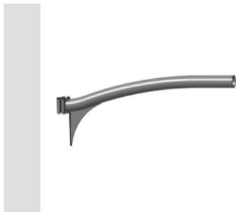
Brazo para fijación en postes de 60-75 mm de diámetro en acero galvanizado en caliente, de 3 mm de espesor, pintado con polvo poliéster. Tornillería en acero inoxidable.
