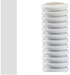
Sistema de tubos de protección curvables de la serie FKHF, fabricados en PP: clasificación 2322, disponibles en siete diámetros, de 16 a 63 mm, con o sin guía tiracables. Apto para sistemas eléctricos o transmisión de datos. Libre de halógenos conforme a la norma EN 60754-2 y baja emisión de humos conforme a la norma EN 61034-2. Apto para aplicaciones dentro de falsos techos y suelos flotantes y para instalaciones en espacios públicos: colegios, cines, teatros, suburbanos, etc.
