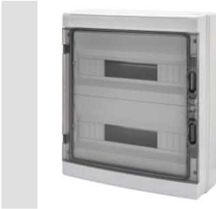
Gama de centralitas estancas IP65 de 8 a 72M con puerta transparente fumé, equipadas con regleta multipolar de conexión por tornillo, 80A IP20. Las principales características técnicas son: frente y panel trasero reversibles, marcos desmontables, paneles con ventana y puerta que abre hasta 180° equipable con cerradura. Las regletas permiten realizar un cableado sencillo y limpio, reduciendo el tiempo de cableado.
