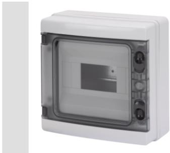
Gama de centralitas estancas IP65 de 8 a 72M con puerta transparente fumé, equipadas con regleta multipolar de conexión por tornillo, 80A IP20. Las principales características técnicas son: frente y panel trasero reversibles, marcos desmontables, paneles con ventana y puerta que abre hasta 180° equipable con cerradura. Las regletas permiten realizar un cableado sencillo y limpio, reduciendo el tiempo de cableado.
