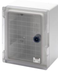
Gama de cuadros estancos en termoplástico GW PLAST 120. En conformidad con las normas IEC 61439-1, IEC 61439-2, IEC 60670-1 e IEC 60670-24. Disponibles en 4 tamaños, en versiones con puerta ciega y transparente, con grado de protección IP55. Accesoriados con paneles con ventana, completos con marco extraíble, para protecciones modulares y de caja moldeada hasta 160A. Particularmente indicados para automatizaciones sencillas y distribución.
