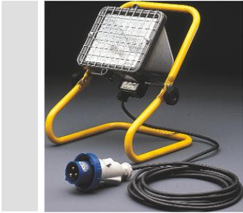
Proyector multifuncional de aluminio inyectado, barnizado con polvo poliéster, para usos móviles en soporte tubular Parábola en aluminio 99.85% abrigantada y oxidada anódicamente Cristal templado de 5 mm Junta de silicona anti envejecimiento Apto para uso con lámparas halógenas Equipado con rejilla de protección, 5 m de cable tipo H07RN-F de 3x1,5 mm<sup>2</sup> de sección y clavija IEC 309 16A 2P+T 200-250V IP67
