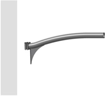
Mastansatzausleger für Durchmesser 60-75mm aus Stahlrohr, feuerverzinkt und mit Polyesterpulver beschichtet. Schrauben und Muttern aus Edelstahl.
