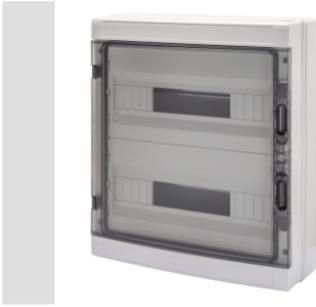
Wassergeschützte Verteiler IP65 von 4 bis 72TE mit transparenter Rauchglastür. Die technischen Merkmale sind: Front und Gehäuse reversibel, abnehmbare Geräteträger und Abdeckungen mit Ausschnitt, abnehmbare Tür mit 180° Öffnung und Schloss als Zubehör. Es können ein- und zweipolige 80 A und 125 A Schraub-Klemmleisten montiert werden; Sie ermöglichen eine einfache und übersichtliche Verdrahtung und verkürzen die Montagezeit.
