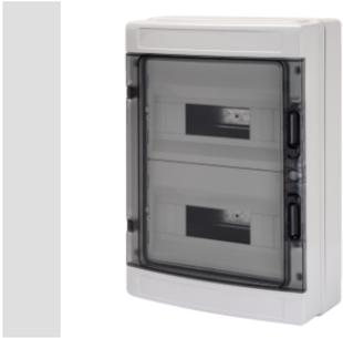
Wassergeschützte Verteiler IP65 von 4 bis 72TE mit transparenter Rauchglastür. Die technischen Merkmale sind: Front und Gehäuse reversibel, abnehmbare Geräteträger und Abdeckungen mit Ausschnitt, abnehmbare Tür mit 180° Öffnung und Schloss als Zubehör. Es können ein- und zweipolige 80 A und 125 A Schraub-Klemmleisten montiert werden; Sie ermöglichen eine einfache und übersichtliche Verdrahtung und verkürzen die Montagezeit.
