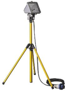
Multifunktionale Scheinwerfer aus Aluminiumdruckguss, beschichtet mit Polyester Pulver für mobile Installationen an einstellbarer Teleskopaufnahme (min. 1m - max. 1,4m). Reflektor aus eloxiertem Reinstaluminium 99,85%. Flachglas, ESG, 5mm. Alterungsbeständige Silikondichtung. Ausgerüstet mit Schutzgitter und Netzleitung H07RN-F - 3x1,5mm<sup>2</sup>, Länge 5m und Stecker nach IEC 309 2P+E 200-250V IP67.
