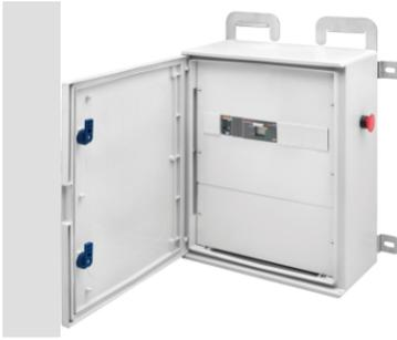
Hauptverteiler für Baustellen vom Typ 68 QP ACS und 68 CDK ACS: Für die Installation direkt nach dem Zähler, für den Schutz der Zuleitung zu den Energieverteilern. Verfügbar in den Bauformen von 17 kW (32A) bis 130kW (250A), alle mit Not-Aus-Taster.
