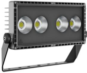
SMART[PRO]e 2M es un proyector LED de media potencia, para exteriores e interiores, adecuado para iluminar zonas e instalaciones deportivas pequeñas y medianas. Se puede instalar en la pared, techo o suelo gracias al soporte en acero galvanizado pintado con polvo de poliéster con pasivación trivalente, equipado con una escala goniométrica ajustable, suministrada en el kit.
