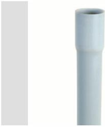
Sistema de tubos de protección de rigidez media de PVC de alta calidad que ofrecen prestaciones superiores. Disponibles en diámetros entre 16 a 32 mm y en longitudes de 2 a 3 metros. Pueden integrarse con tubos flexibles y cajas de derivación. Completa la oferta una amplia gama de racores y componentes con grados de protección desde IP40 a IP67.
