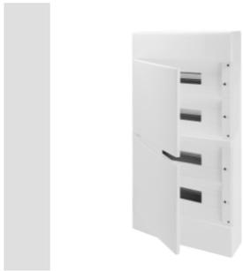
Gamma di centralini da arredo, protetti IP40, disponibili nelle taglie da 8 a 72M. Garantiscono un'elevata integrazione estetica ed sono equipaggiati con morsettiere a vite multipolari, 80 A IP20. Disponibili con porte trasparente fumè o cieche bianche accessoriabili con serratura di sicurezza e contraddistinte dal sistema di apertura e chiusura "PUSH". Le morsettiere consentono di realizzare un cablaggio semplice ed ordinato riducendo i tempi per la messa in opera del centralino.
