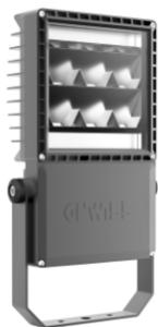
Le SMART [PRO] 2.0 est un projecteur LED intérieur et extérieur de puissance moyenne, adapté à l'éclairage des zones et des installations sportives. Il s'installe au mur, au plafond ou au sol grâce à son support en acier galvanisé enduit de poudre de polyester, avec passivation trivalente, équipé d'une échelle goniométrique réglable et fourni dans un kit. Le corps est en aluminium coulé sous pression
