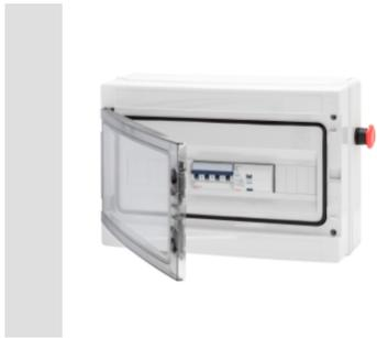
Principaux tableaux d'alimentation pour le site de construction (types 68 QP ACS et 68 CDK ACSK): installés juste en aval du compteur d'énergie afin de protéger la ligne entre le coffret d'alimentation et le tableau de distribution principal du site. Ils sont proposés dans des versions de 17 kW (32 A) à 130 kW (250 A) de puissance et sont tous équipés d'un bouton poussoir d'urgence.
