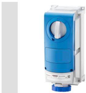
Gamme de produits constituée de prises industrielles conformes IEC 60309, avec verrouillage mécanique par commutateur rotatif, pour une utilisation individuelle ou groupée sur bases modulaires. La robustesse des produits, leur résistance face aux agressions des principaux agents chimiques et atmosphériques, ainsi que l'indice de protection élevé IP 66 permettent une installation dans des environnements difficiles, avec des conditions atmosphériques difficiles.
